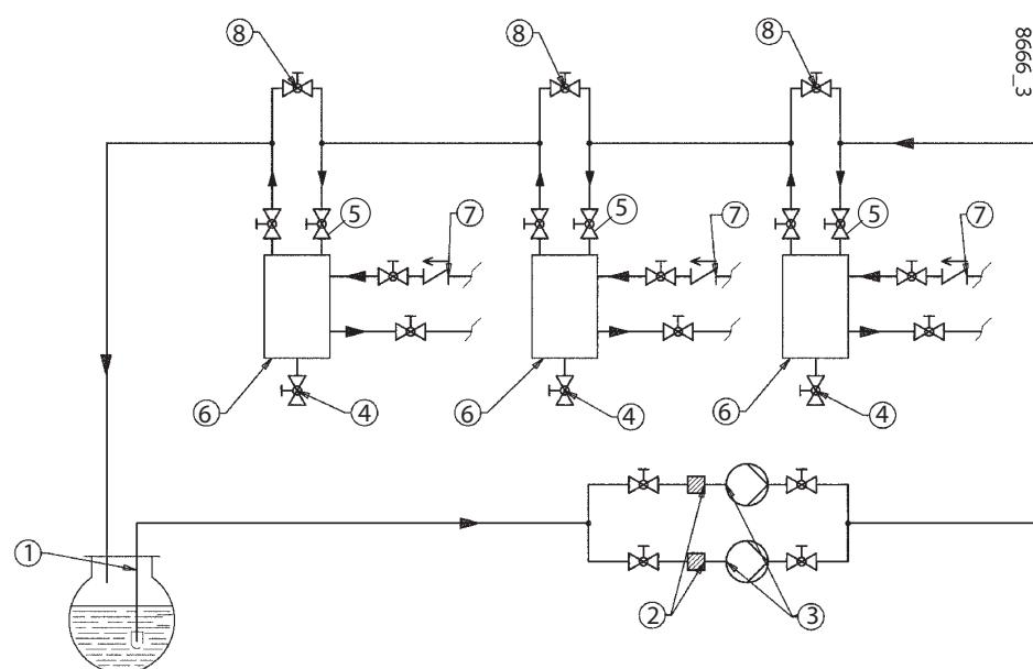
Емкости для рекуперации топлива (диаметр ~ 150 мм и высота ~ 400 мм) должны устанавливаться как можно ближе к горелке, по крайней мере, на 0,5 м выше насоса горелки.
