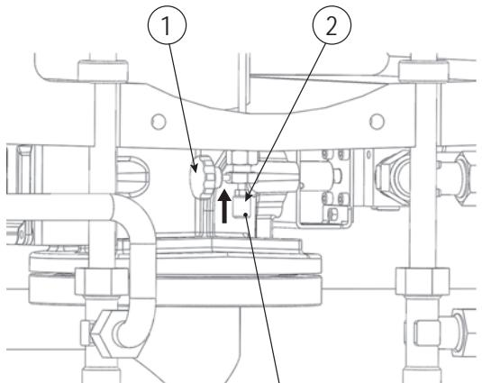
Положение штока с вспомогательным воздухом при ЗАКРЫТОЙ форсунке при работе на дизельном топливе.
