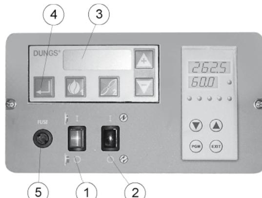
1 Главный выключатель ВКЛЮЧЕН/ОТКЛЮЧЕН
